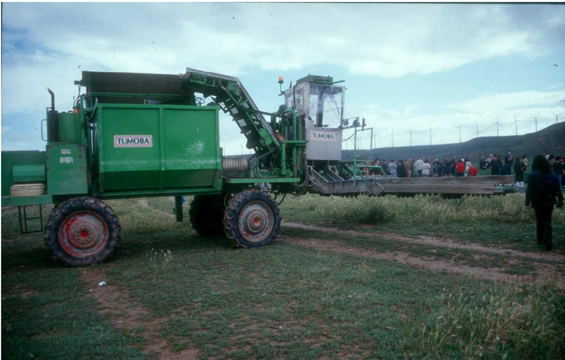
**Foto 7.-** Prototipo para recolección mecanizada de alcachofa.
