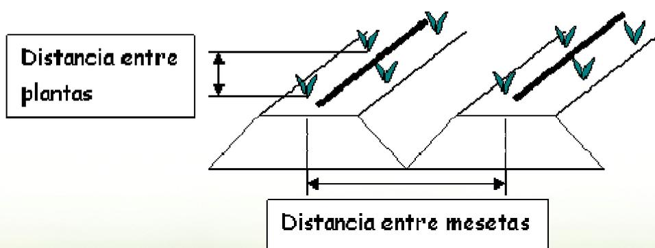
En el caso del riego localizado, al realizar la plantación en líneas dobles dispuestas al tresbolillo con una línea de goteo por bancada, permite reducir la cantidad necesaria de tubería portagotero y, por lo tanto, los costes de cultivo.
