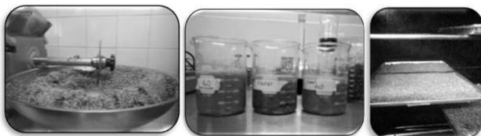
Molienda, extracción y secado de los residuos agrícolas de brócoli.
