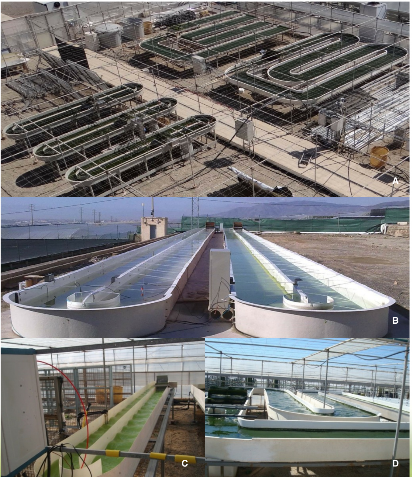
Imagen 4. A, vista aérea de diferentes tipos de raceway. B, raceways de gran capacidad (50.000 L). C y D, detalle del movimiento del cultivo en estos sistemas. Todos estos raceway están localizados en la Estación Experimental de Cajamar.
