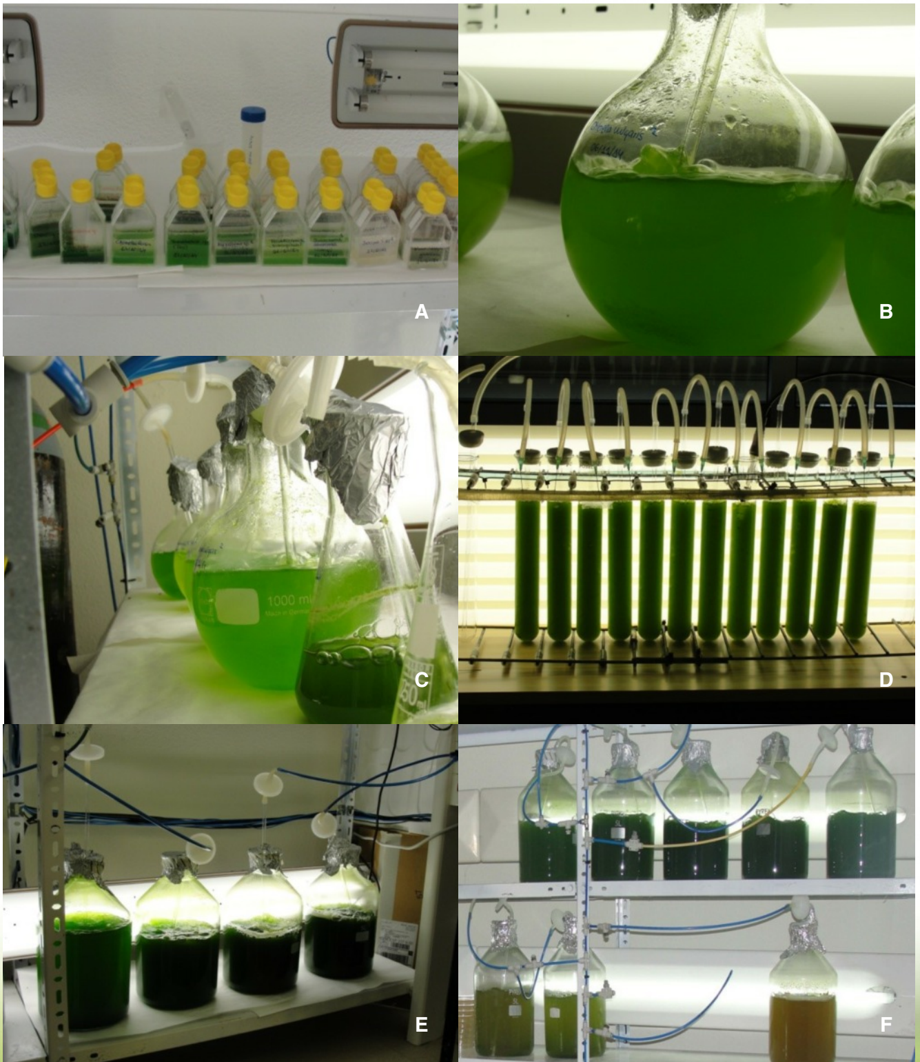
Imagen 6. Diferentes fotografías de recipientes para producir microalgas en cámara. A. Conservación de cepas de microalgas. B y C matraces esféricos. D. tubos verticales con aireación. E y F, matraces de 5 L
