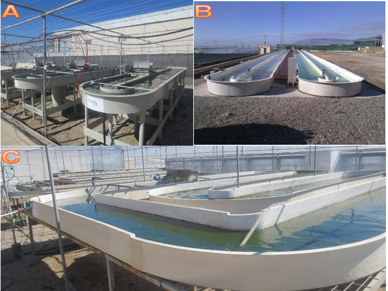
Imagen 2: Diferentes sistemas abiertos de producción de microalgas que es posible encontrar en las instalaciones de la Estación Experimental Cajamar Las Palmerillas. Sistemas raceway (A, B y C)
