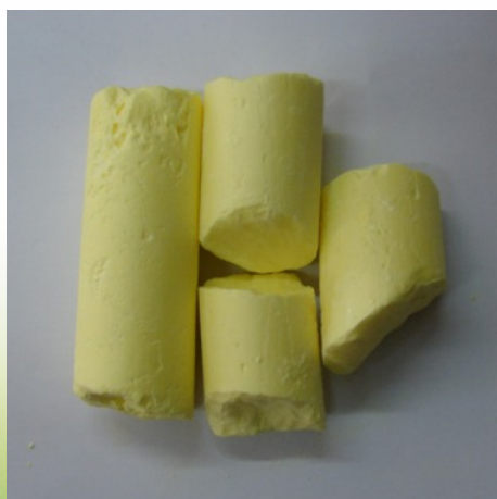
Imagen 5: Cilindros de azufre utilizados en los sublimadores
