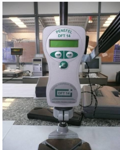
Imagen 3: Penetrómetro Penefel DFT 14 sobre soporte fijo
