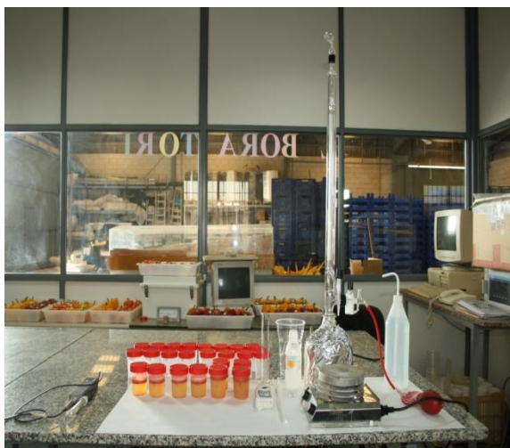
Imagen 5: titrador semi automatico para valoración de acidez
