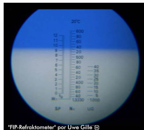
Imagen 3: Refractómetro manual. Este modelo es portátil y de bajo coste. Detalle de la medida en la interfase clara y oscura que se forma
