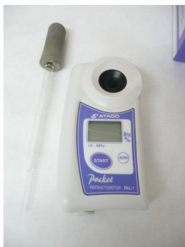
Imagen 2: Refractómetro digital modelo Atago Pal 1. Este modelo es portátil, de bolsillo y de bajo coste
